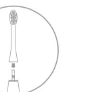
Вставьте насадку в корпус зубной щетки до упора. Чтобы насадка щетки могла нормально функционировать, между головкой и основным корпусом необходимо оставить небольшой зазор примерно 0,5мм.
